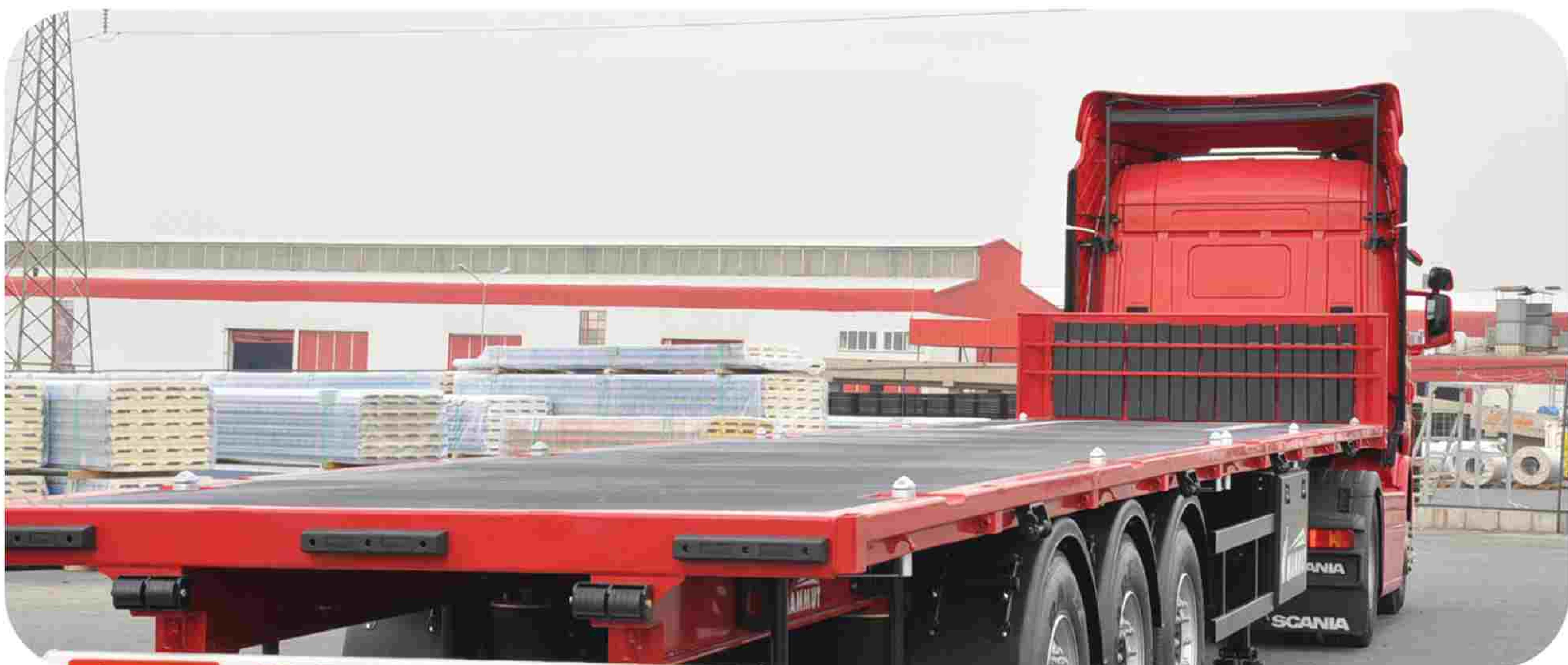
بسته های ساندویچ پانل حداکثر به صورت دو طبقه بر روی هر تریلر قرار خواهند گرفت.
