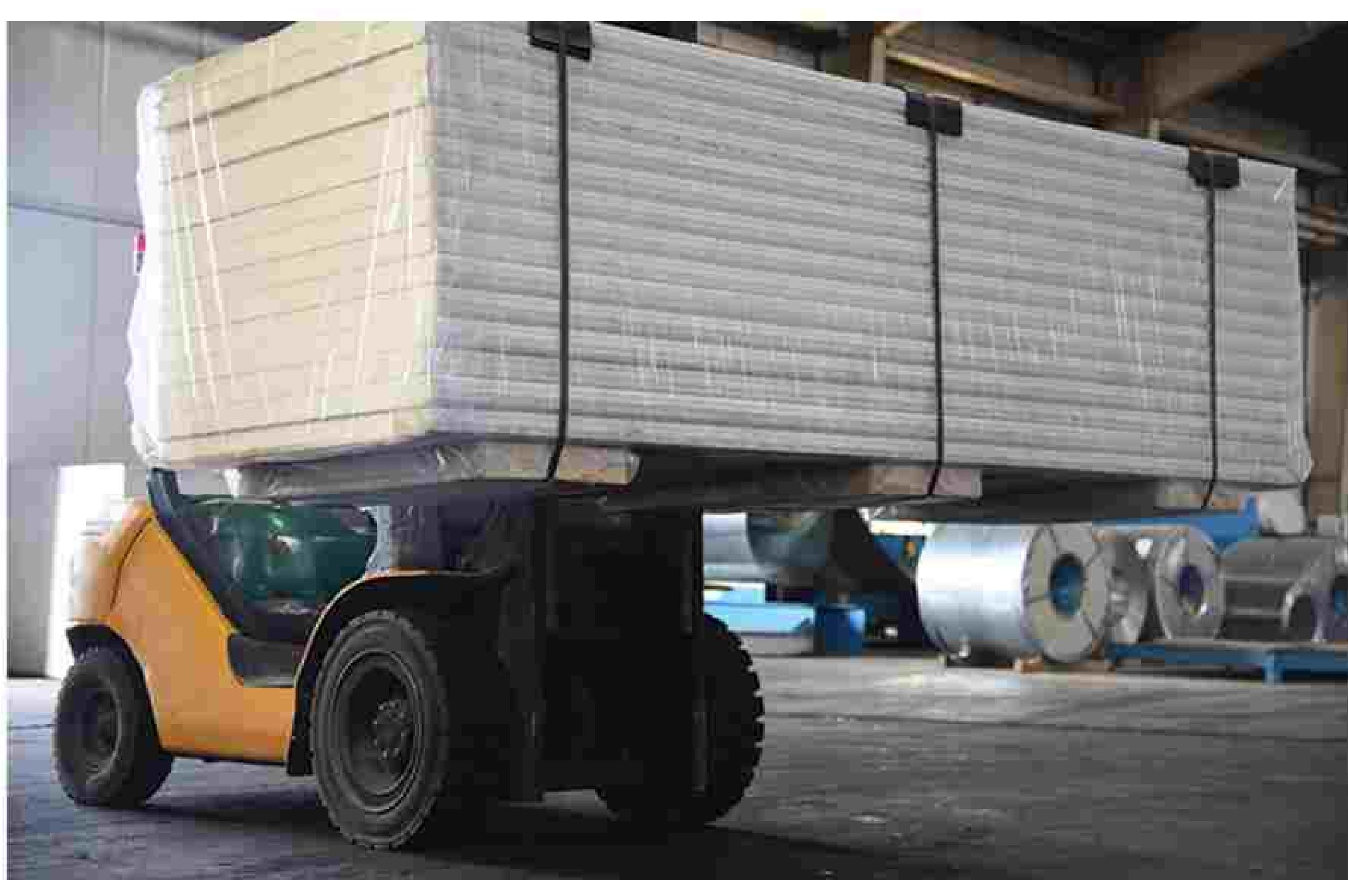
برای برداشتن بسته های ساندویچ پانل با طول کمتر از ۶ متر از لیفتراک دو شاخه با ظرفیت ۶ تن یا چرثقیل تلسکوپی (با استفاده از تسمه های پارچه ای) استفاده گردد.
