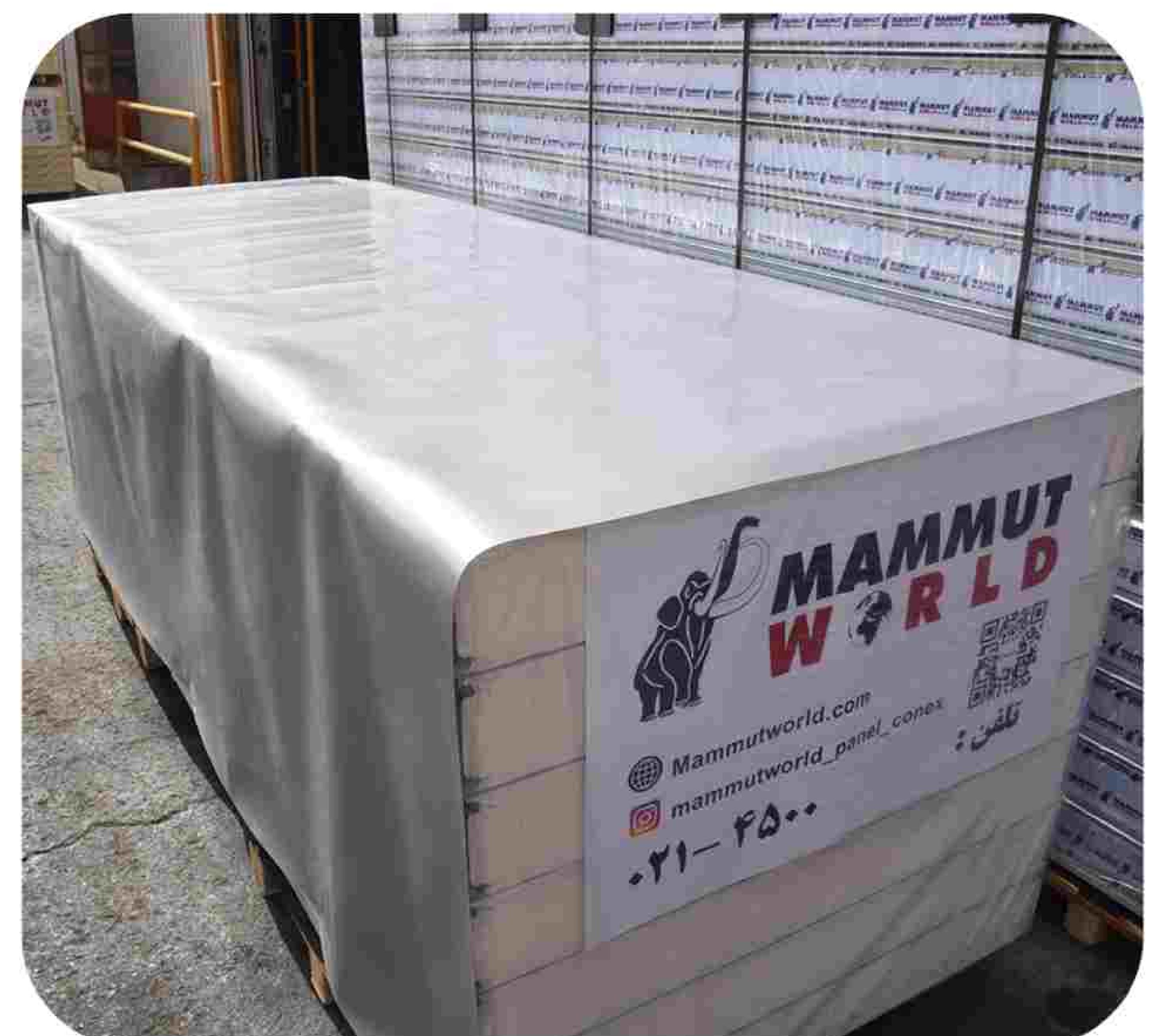
پوشش پلی اتیلن روی صفحات ساندویچ پانل در صورت قرار گرفتن بسته ها در فضای باز قبل از ۷ روز و در فضای مسقف قبل از ۱۴ روز باید جدا گردد.
