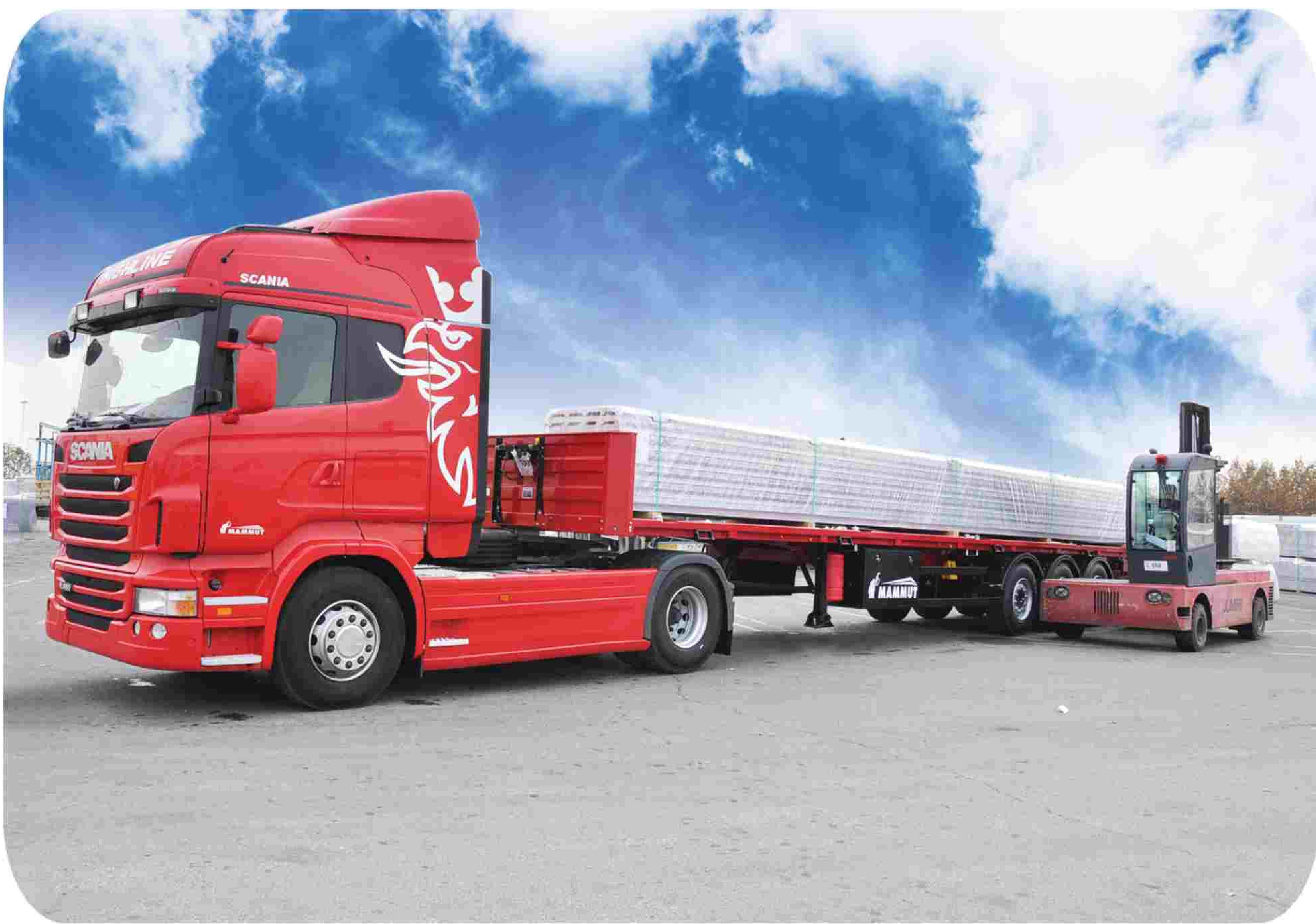
استفاده از هر نوع سیم بکسل، طناب یا زنجیرهای فلزی برای مهار بار باعث آسیب جدی به صفحات ساندویچ پانل می گردد.
